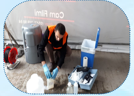
Atık Su Numune Alımı
