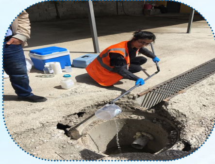
Atık Su Numune Alımı
